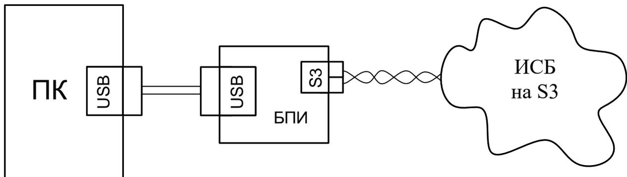
**ВНИМАНИЕ!** При работе в ПО АРМ «Стрелец-Интеграл» или «Стрелец-Мастер» (в режиме длительного времени включённого протоколирования событий) через БПИ, рекомендуется в настройках операционной системы (ОС) отключить опцию «Разрешить отключение этого устройства (и/или корневого USB-концентратора) для экономии энергии» (название опции может отличаться в зависимости от ОС).
