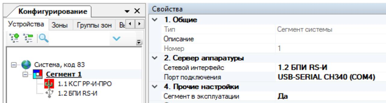
Программирование БПИ, являющегося сетевым интерфейсом данного ПК, происходит автоматически при его первом использовании. Остальные БПИ программируются аналогично другим устройствам в сегменте согласно руководству по эксплуатации интегрированной системы безопасности "Стрелец-Интеграл" СПНК.425513.039 РЭ.
