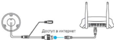
Рисунок 5-3 Подключение к роутеру
